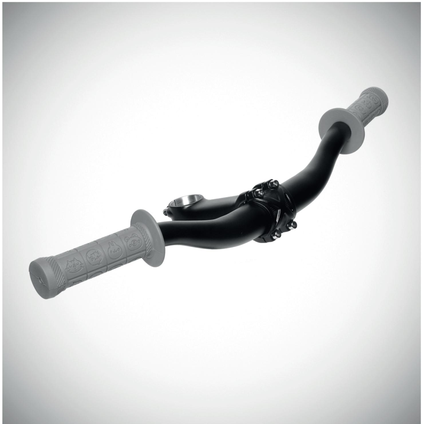
**1** Installez la potence sur le cintre en utilisant 4 rondelles M5 et 4 vis M5. La mention «DOWN» (BAS) sur les deux parties de la potence qui viennent s'assembler, vous indique le sens de montage. Positionnez le cintre comme sur l'image suivante et serrez les 4 vis M5 à 5Nm.
