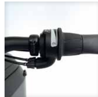
La poignée tournante du moyeu ENVIOLLO
