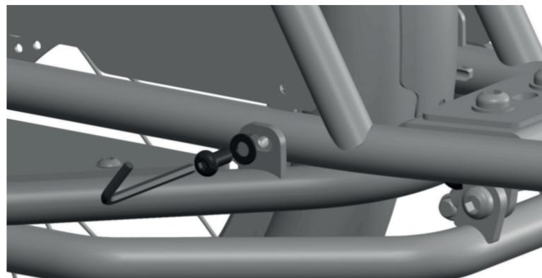
**3** Insérez la partie arrière du Repose Pieds dans le tube du porte bagage et prévissez avec 2 vis M8 de 16mm.
