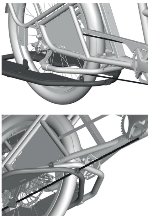
! Dans le cas où le Repose Pieds ne serait pas aligné avec le trou du cadre, un ajustement du porte bagage est nécessaire. Pour cela, réglez la hauteur du porte bagage en desserrant légèrement les deux vis situées sur le haut ainsi que les deux vis de chaque flanc.
