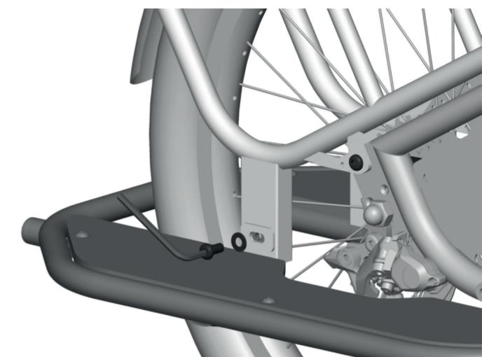
**4** Vissez et serrez la vis de jonction à l'avant du Repose Pieds (12 à 14Nm).
