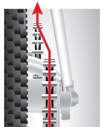
SPROCKETS ARE NOT ALIGNED
