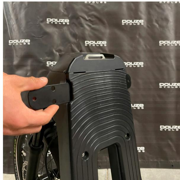
**2** Visser la plaque de fixation avec 4 vis M6 de 20mm.
